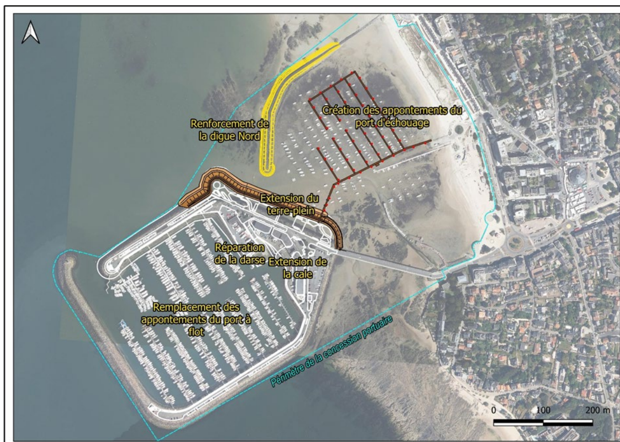
Figure 1-2 Extrait du document de PRO illustrant la localisation des différents aménagements maritimes
