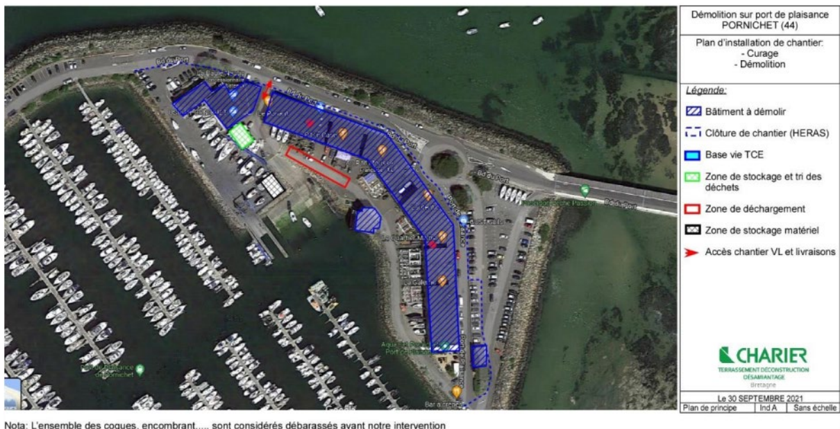
Figure 1-13 : Plan d'installation du chantier
