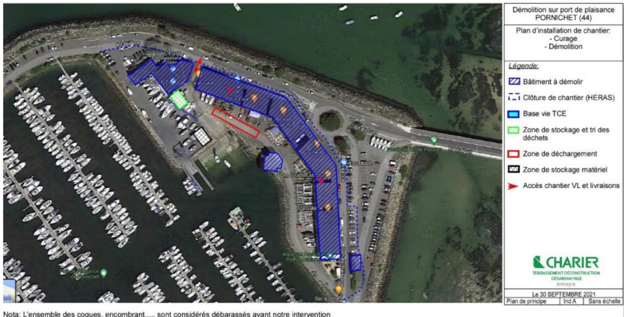
Figure 6-22 - Plan d'installation du chantier
