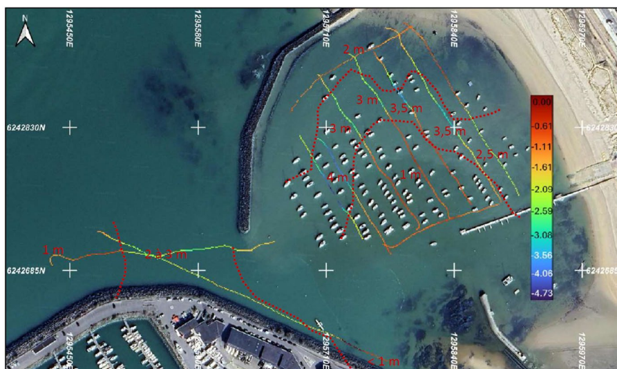
Figure 2-6 – Représentation des épaisseurs de sédiments (G2 PRO Fondouest)
