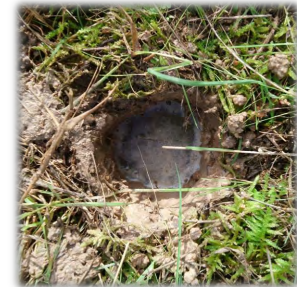
Engorgement dès les premiers centimètres Source CERMECO
