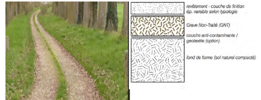
Fig.21 Mise en œuvre d'une piste lourde en « terre-pierre »
