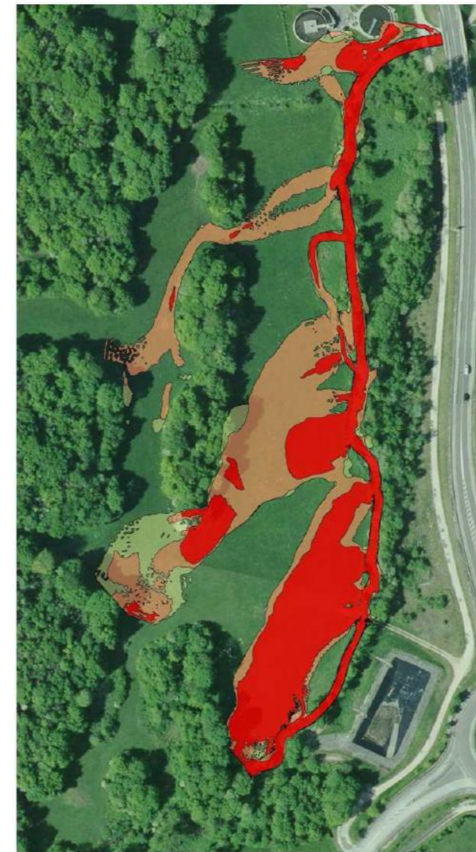
Figure 11 : Carte des aléas inondation pour l'état initial
