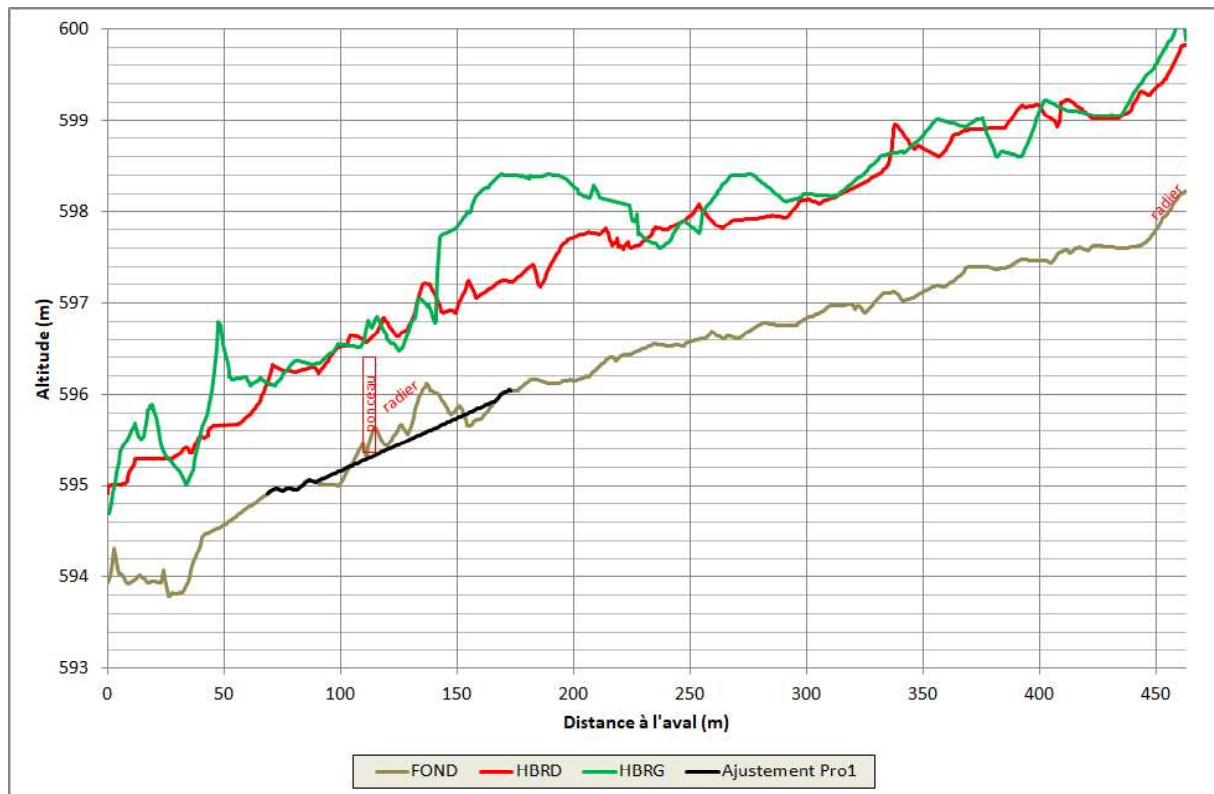
Figure 8 - Profil en long général du Murgin dans la zone d'étude, faisant apparaître le ponceau et le radier associé
