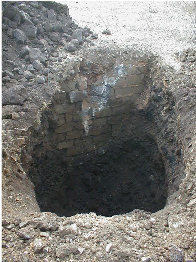
vue des argiles molles sous-jacentes aux remblais et ne présentant pas d'odeur particulière (PM71)
