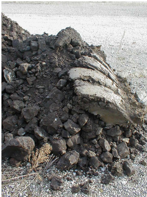
vue des argiles molles sous-jacentes aux remblais et ne présentant pas d'odeur particulière (PM71)
