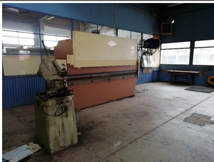
Vue de l'intérieur de l'atelier : presse plieuse
