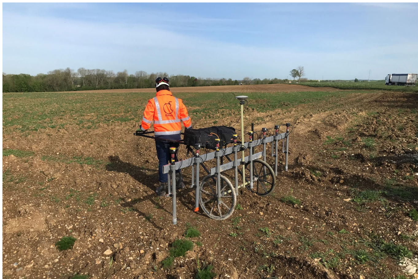
Figure 4 : Magnétomètre multisonde Vallon (8 sondes) monté sur un chariot amagnétique.
