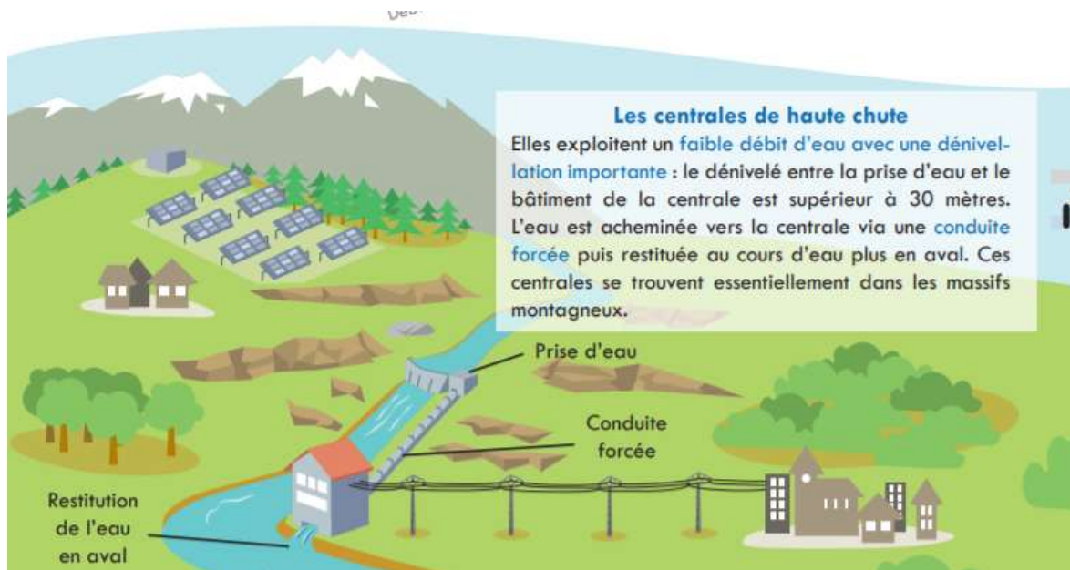
Figure 2. Schéma de principe d'une centrale de haute chute (source FHE)
