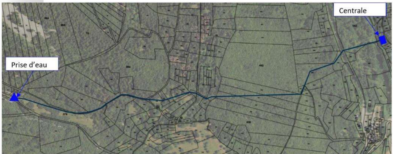
Figure 46.. Cheminement de la conduite forcée
