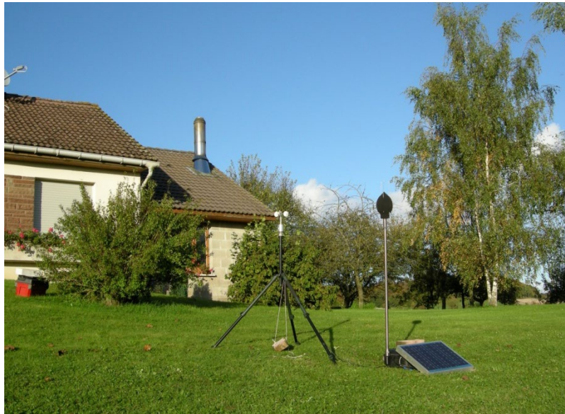
Figure 11 : Photographie d'un sonomètre en cours d'utilisation
