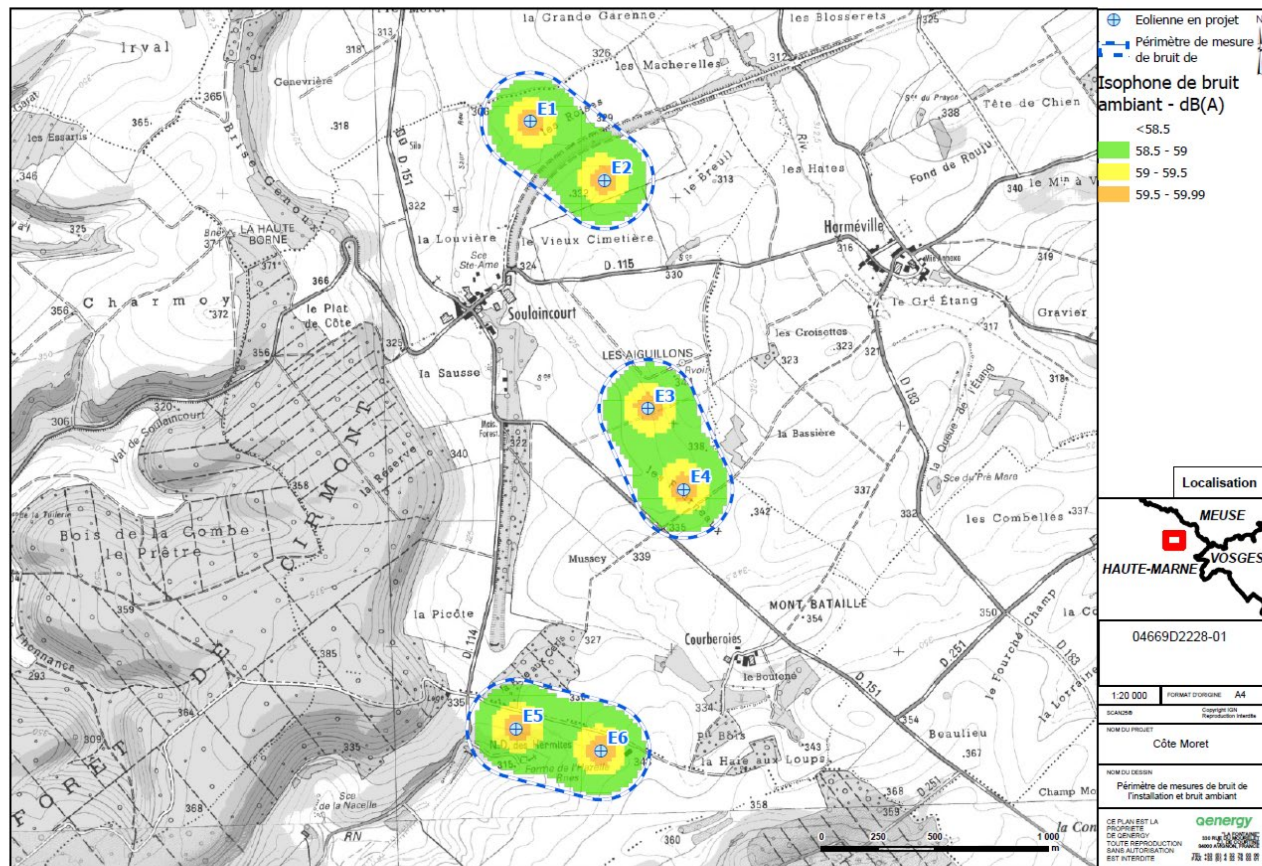
Figure 20 : Périmètre de mesure du bruit du parc éolien et bruit ambiant
