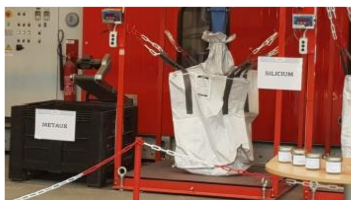
Figure 7 : Séparation et triage des composants (Source : REDEN)
