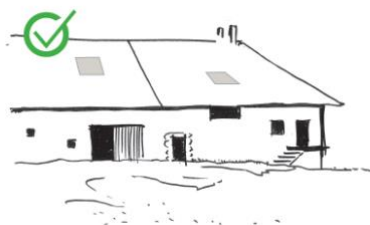
Menuiseries dans la pente de la toiture
