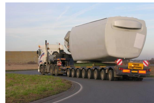
Transport de la nacelle
