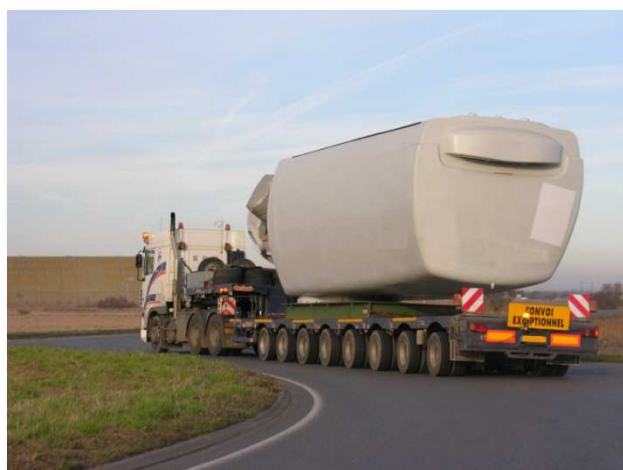
Photo 118 : Transport de nacelle (Source : VALOREM)
