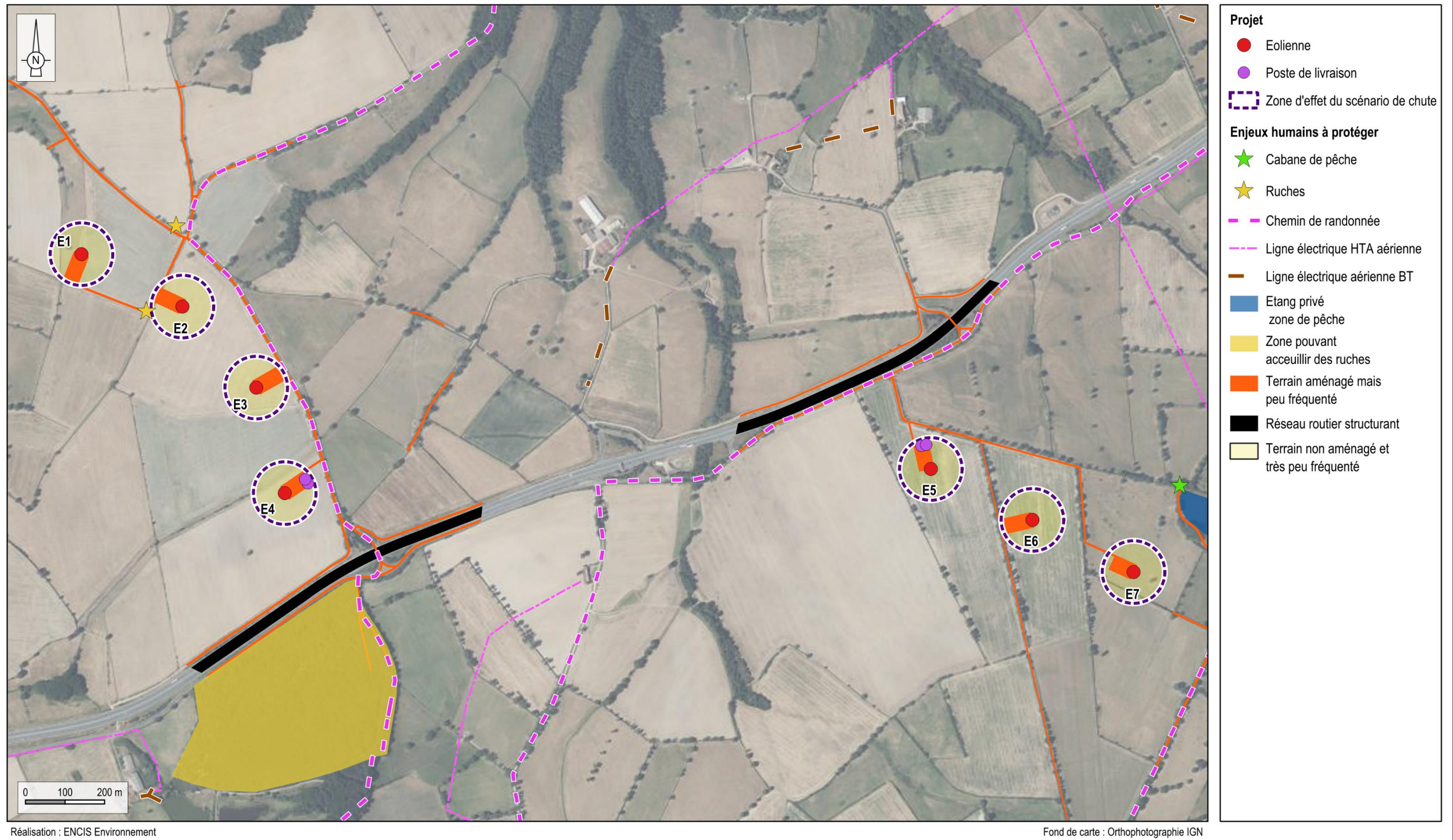
Carte 15 : Cartographie des enjeux identifiés dans les zones d'effet du scénario de chute de glace
