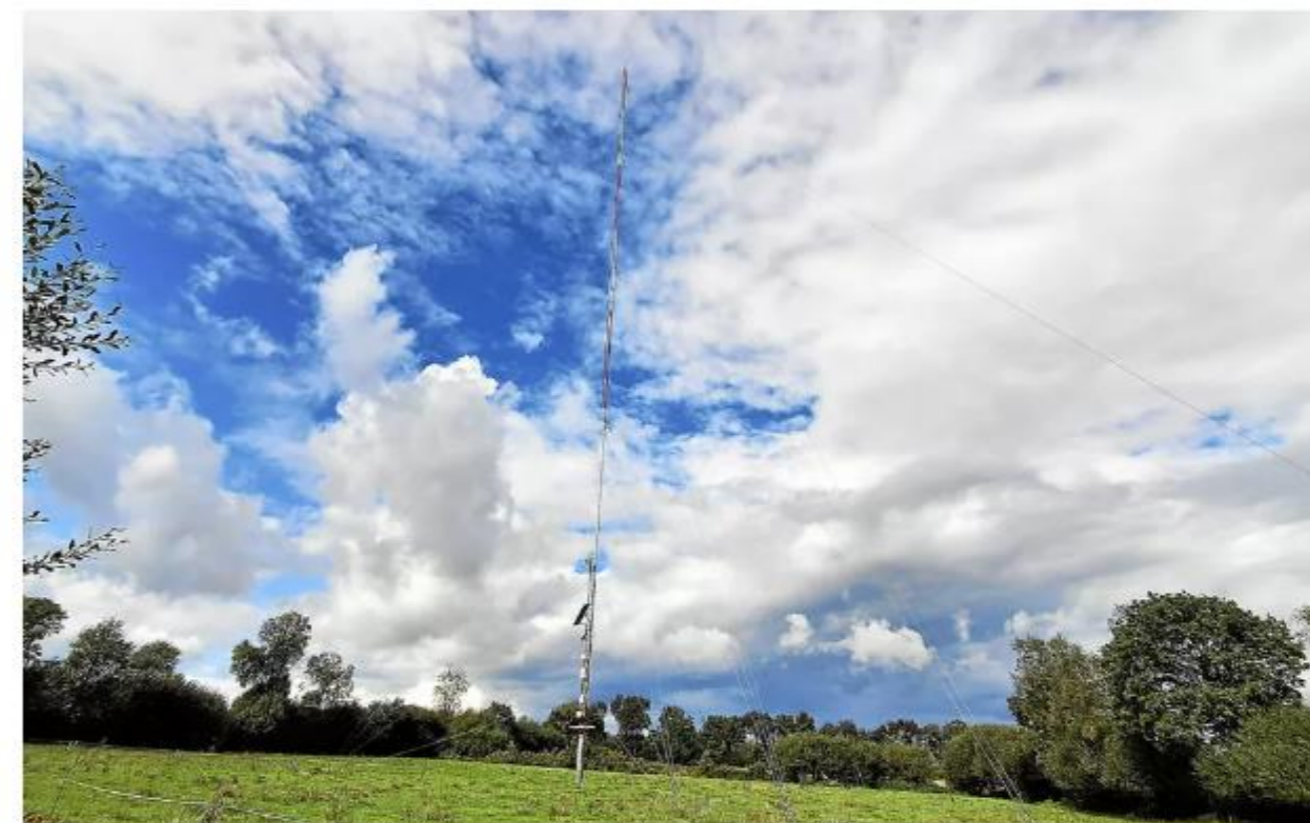
Le mât de mesure, d'une hauteur de 91 m, est composé de cinq anémomètres, deux girouettes, un thermohygromètre, un baromètre et un micro d'écoute.
