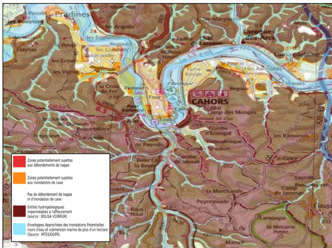
Figure 84 : Aléas de remontée de nappe
