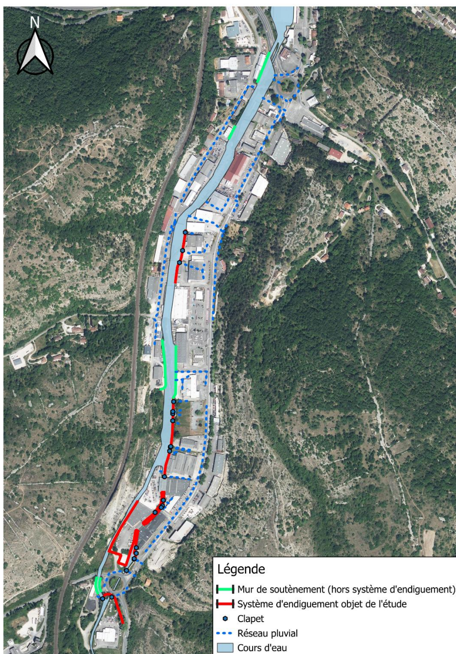
Figure 34 : Composition du Système d'Endiguement – Exutoires pluviaux
