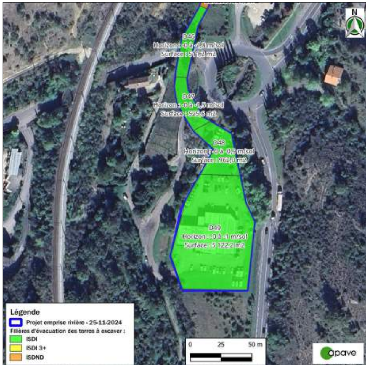
Figure 15 : Cartographies des horizons de surface (jusqu'à 2 m de profondeur) des zones de terrassement avec identification des filières d'acceptation correspondantes
