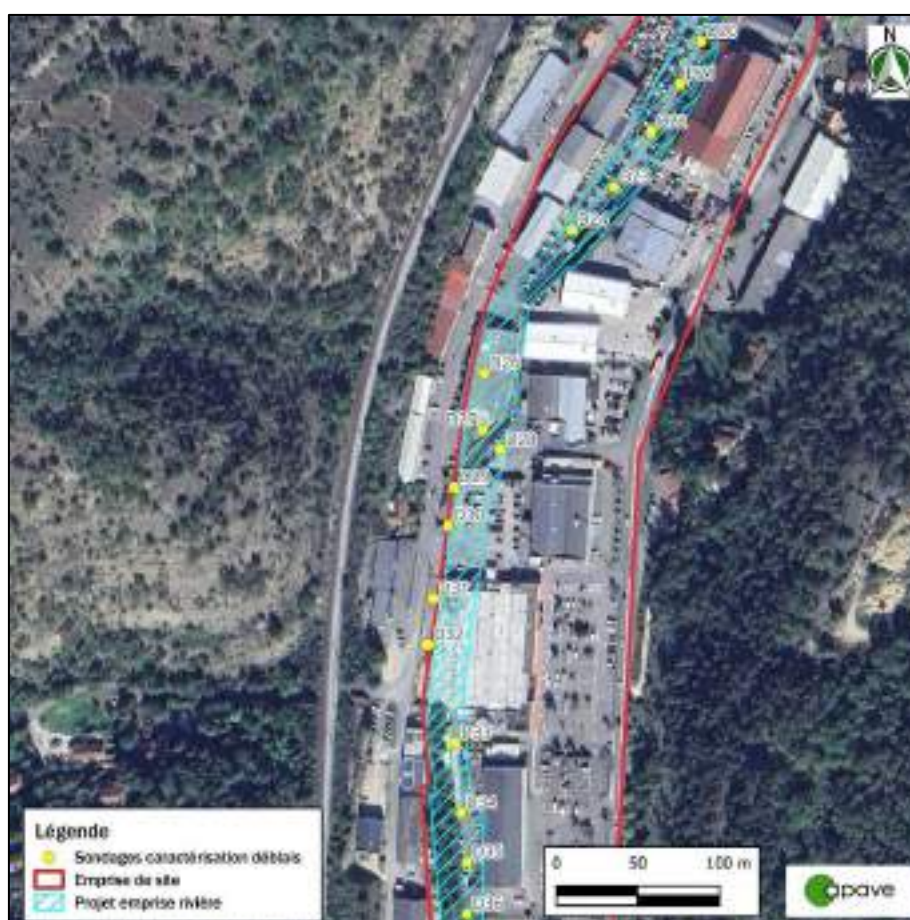
Figure 13 : Localisation sondages terres à excaver - partie 2
