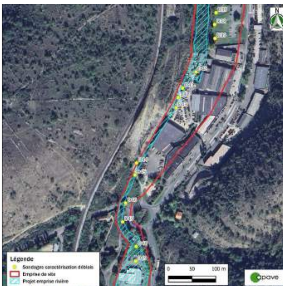
Figure 14 : Localisation sondages terres à excaver - partie 3
