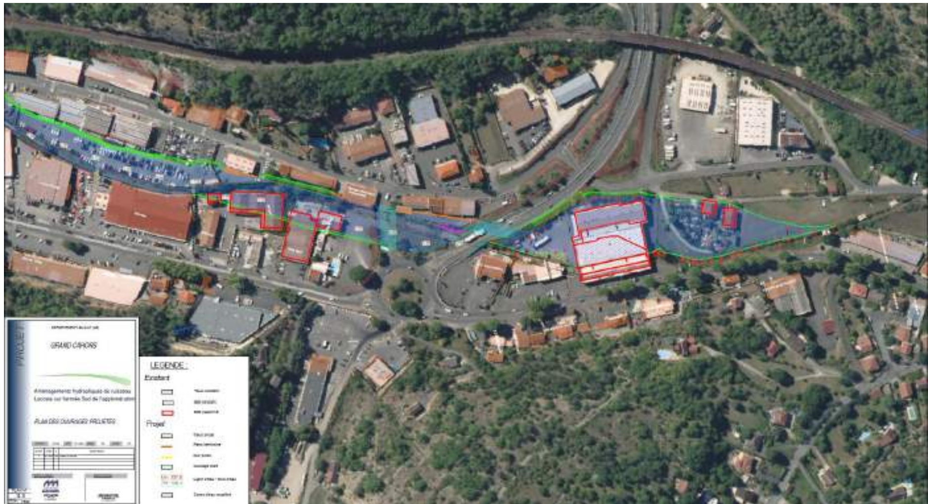
Figure 6 : Aménagement hydraulique du cours d'eau le Lacoste sur l'Entrée Sud de Cahors – secteur aval.
