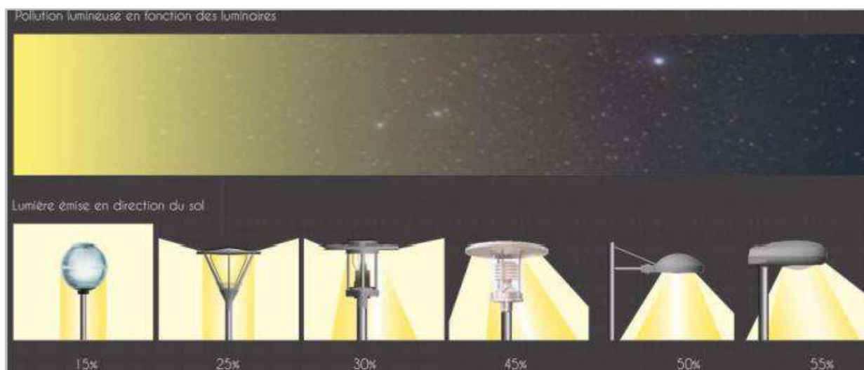
Figure 8 : Efficacité du flux et pollution lumineuse en fonction du type de luminaire ; © OFB
