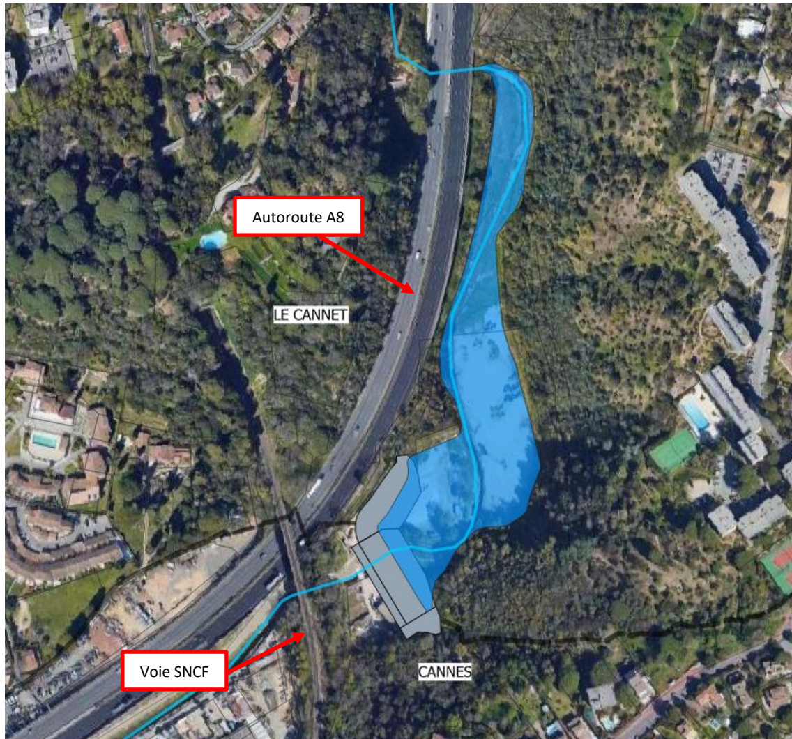
Figure 4 - Zoom sur l'aménagement hydraulique de Carimaï (Fond de plan Google Satellite 2023)
