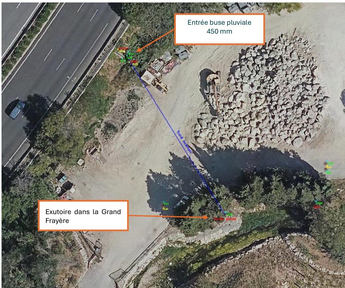
Figure 22 : Entrée et exutoire de la buse pluviale - Source : Plan topographique du 11/08/2023
