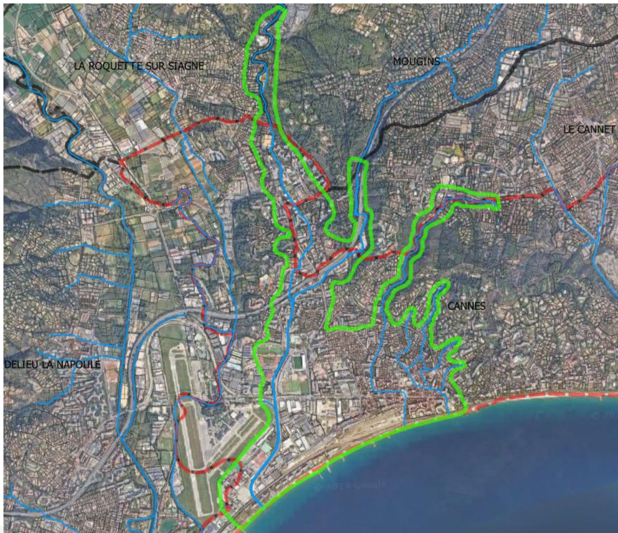
Figure 4-1 : Emprise du modèle hydraulique PPRi (en vert)
