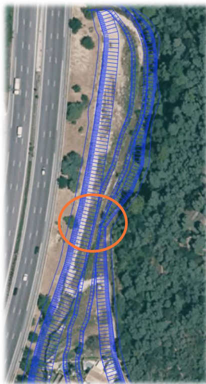
Figure 26 : Etranglement topographique en fond de bassin post-aménagement
