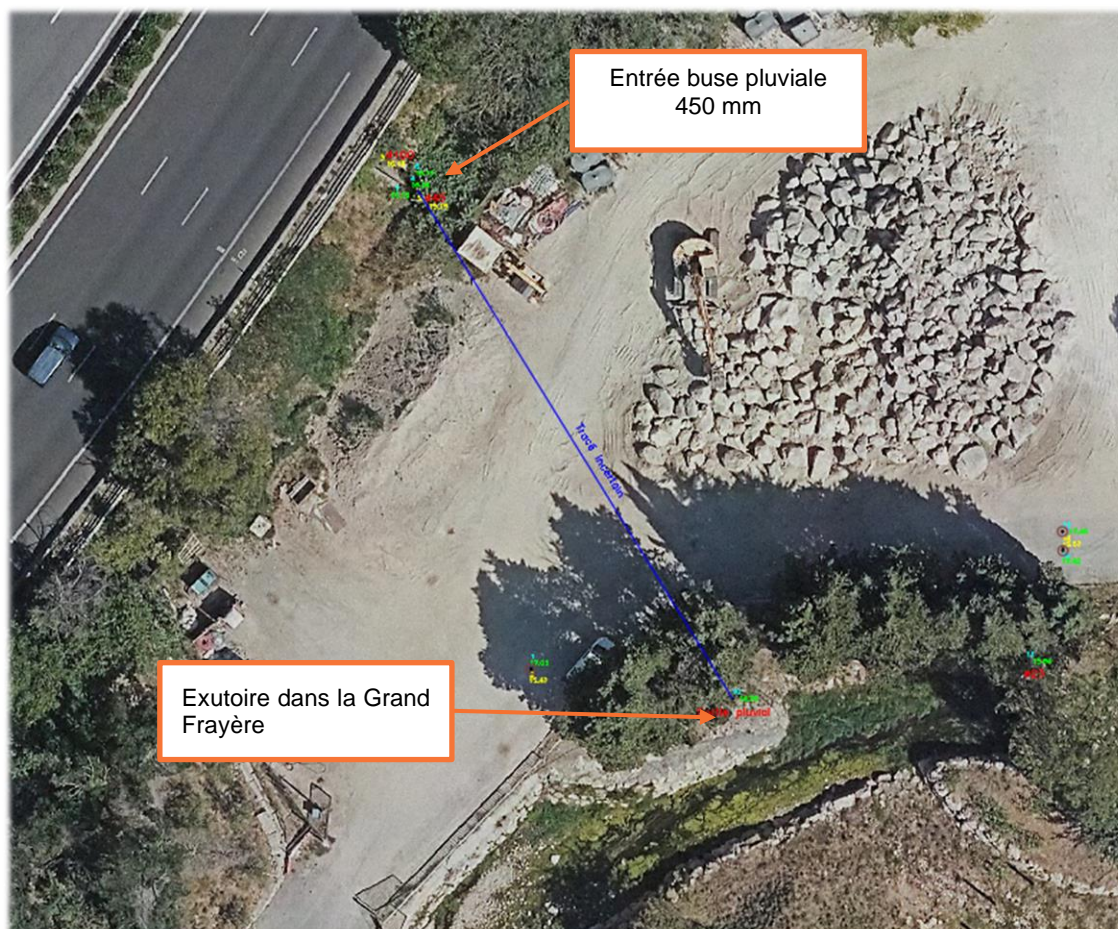
Figure 31 : Entrée et exutoire de la buse pluviale - Source : Plan topographique du 11/08/2023
