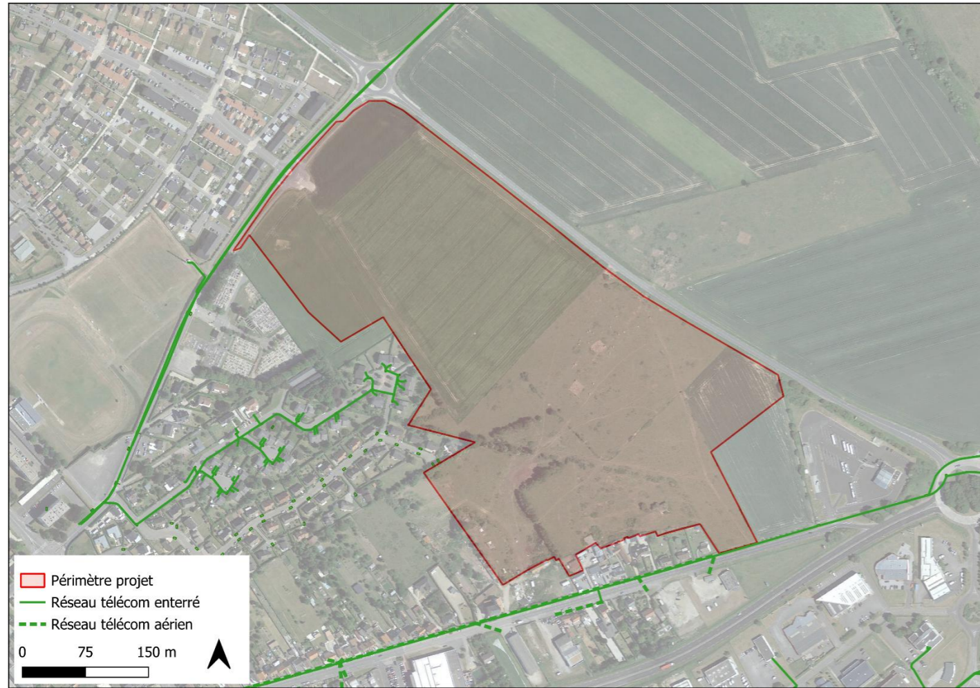
Figure 127 : Réseaux télécom (INGETEC)
