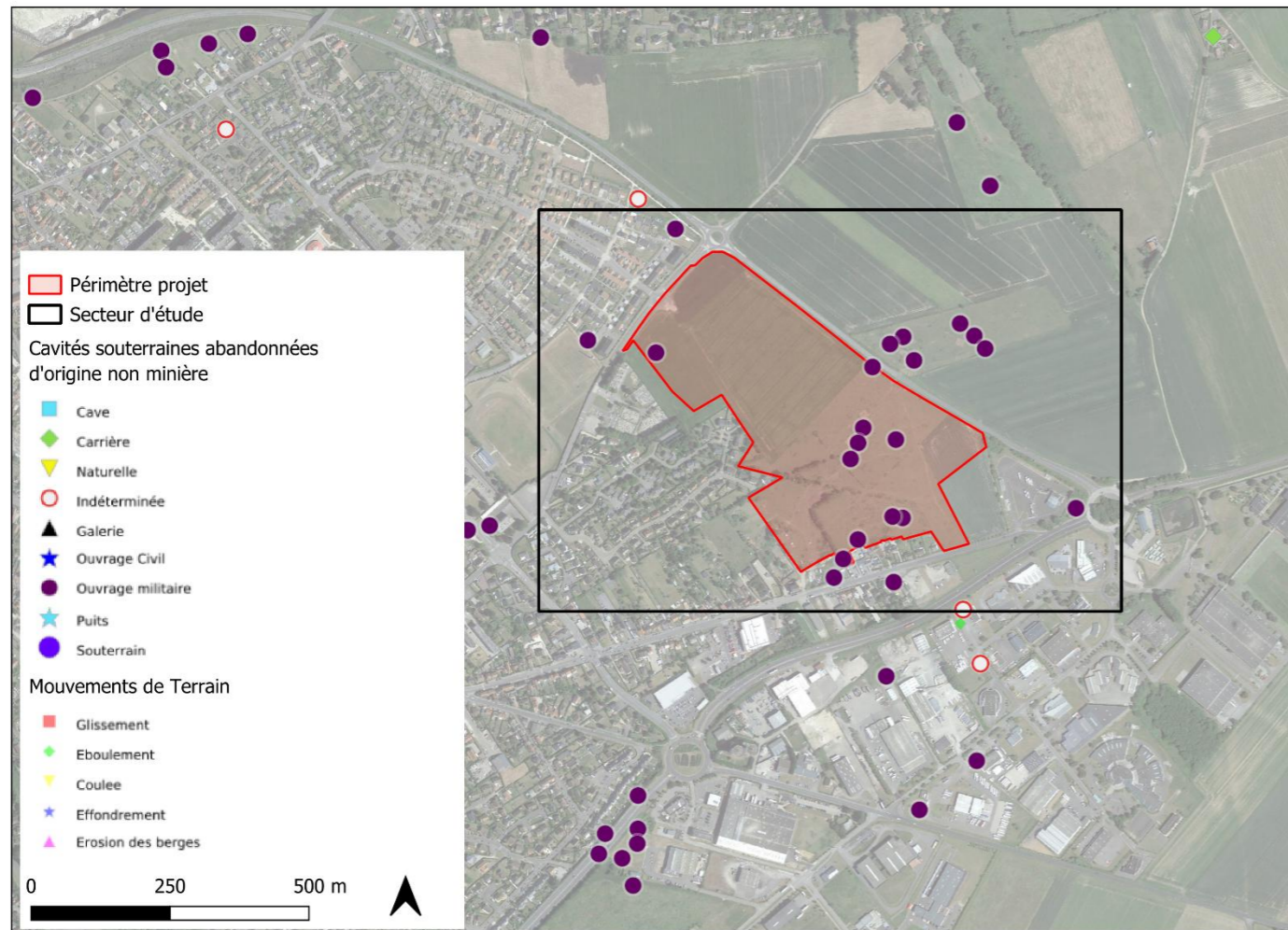
Figure 38 : Mouvements de terrains et cavités souterraines recensées à proximité du secteur d'étude (BRGM)
