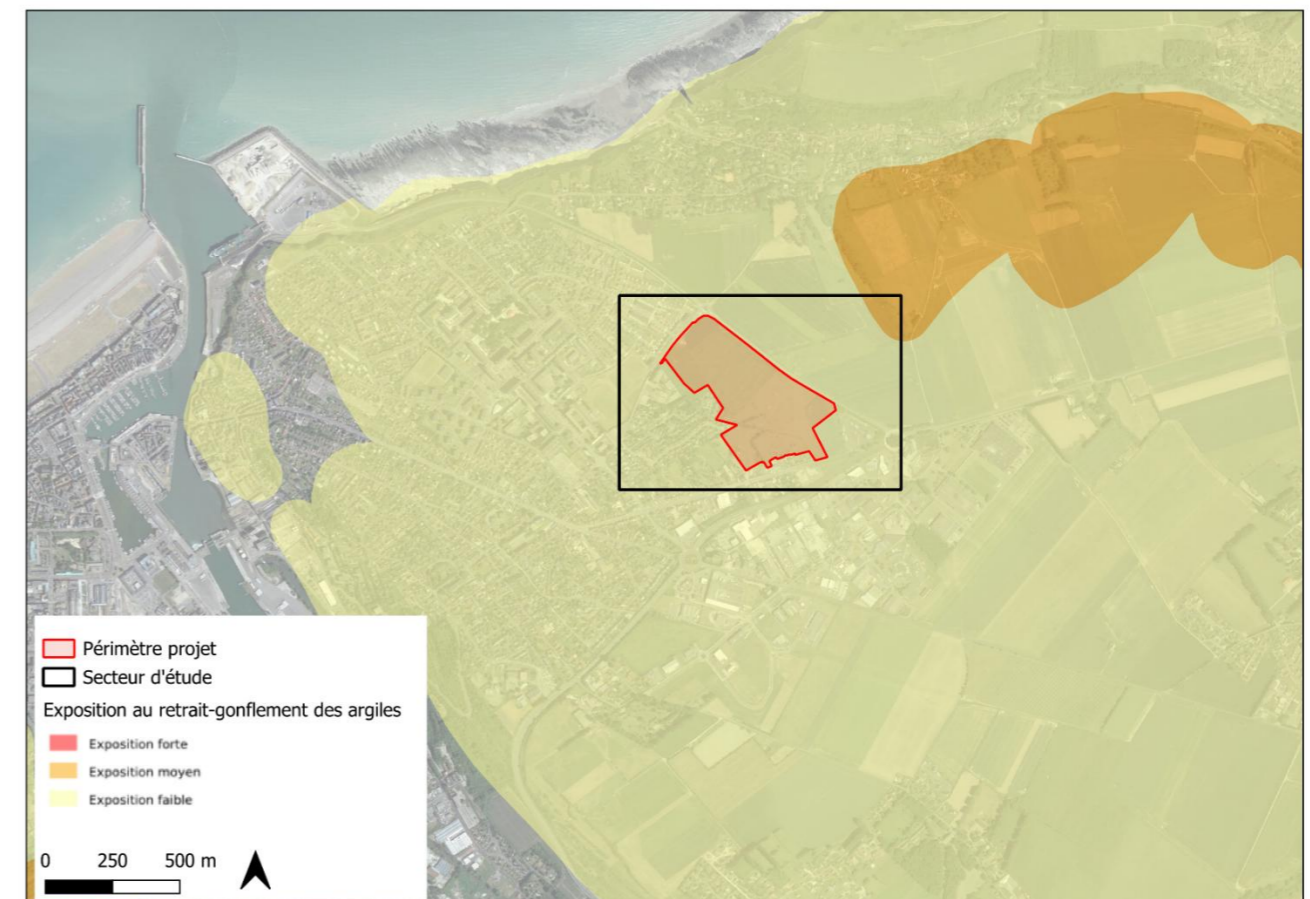
Figure 37 : Exposition au retrait gonflement des argiles (BRGM)
