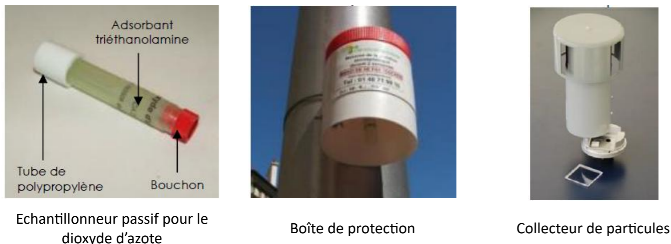
Figure 133 : Systèmes de prélèvement mis en œuvre dans la cadre du projet (Airea)
