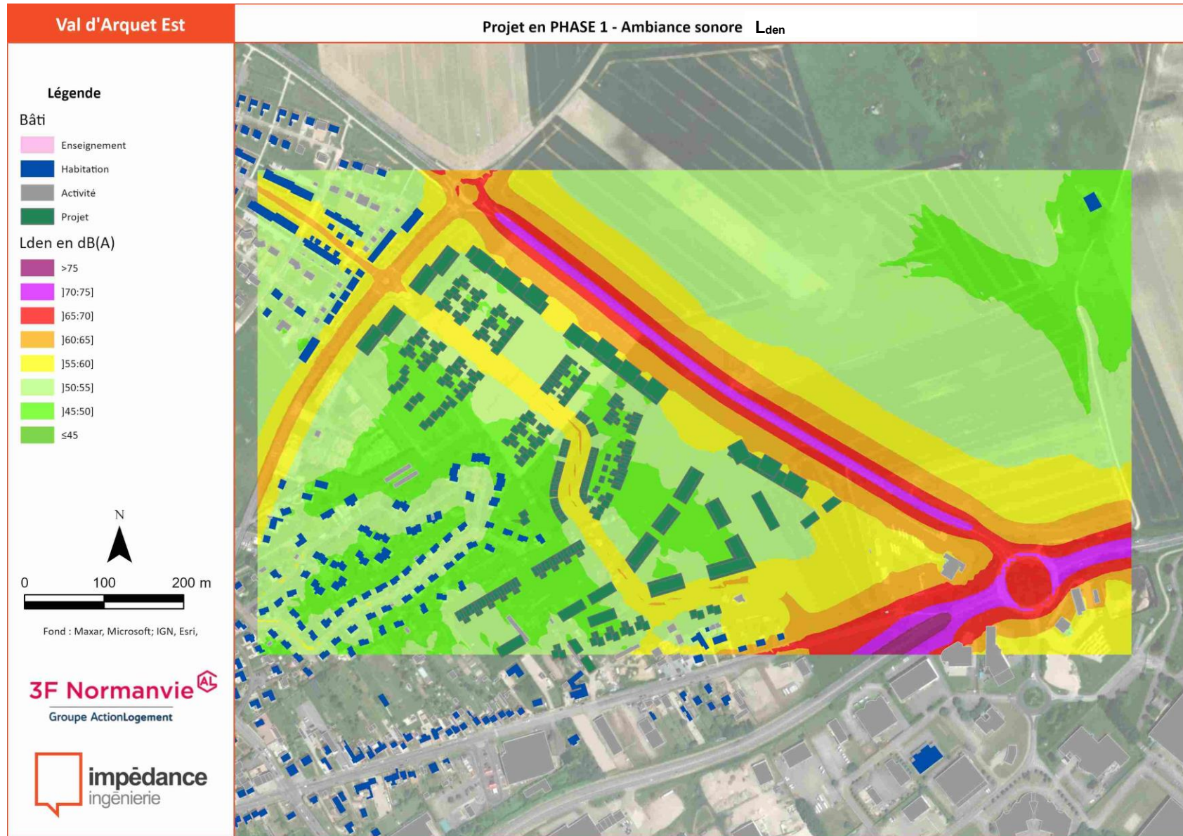
Projet PHASE 1 : Carte de niveaux sonores L_{den} estimés à 4m du sol, en dB(A)
