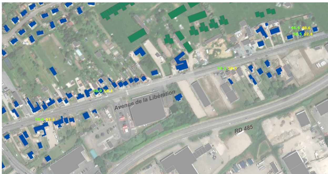
Niveaux sonores diurnes en façades des habitations existantes au Sud du projet : actuels en vert et en jaune en Phase 2, en dB(A).
