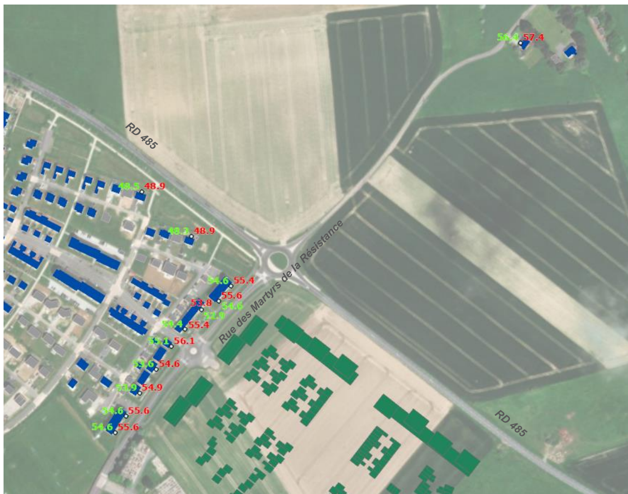
Niveaux sonores diurnes en façades des habitations existantes au Nord du projet : actuels en vert et en rouge en Phase 1, en dB(A).
