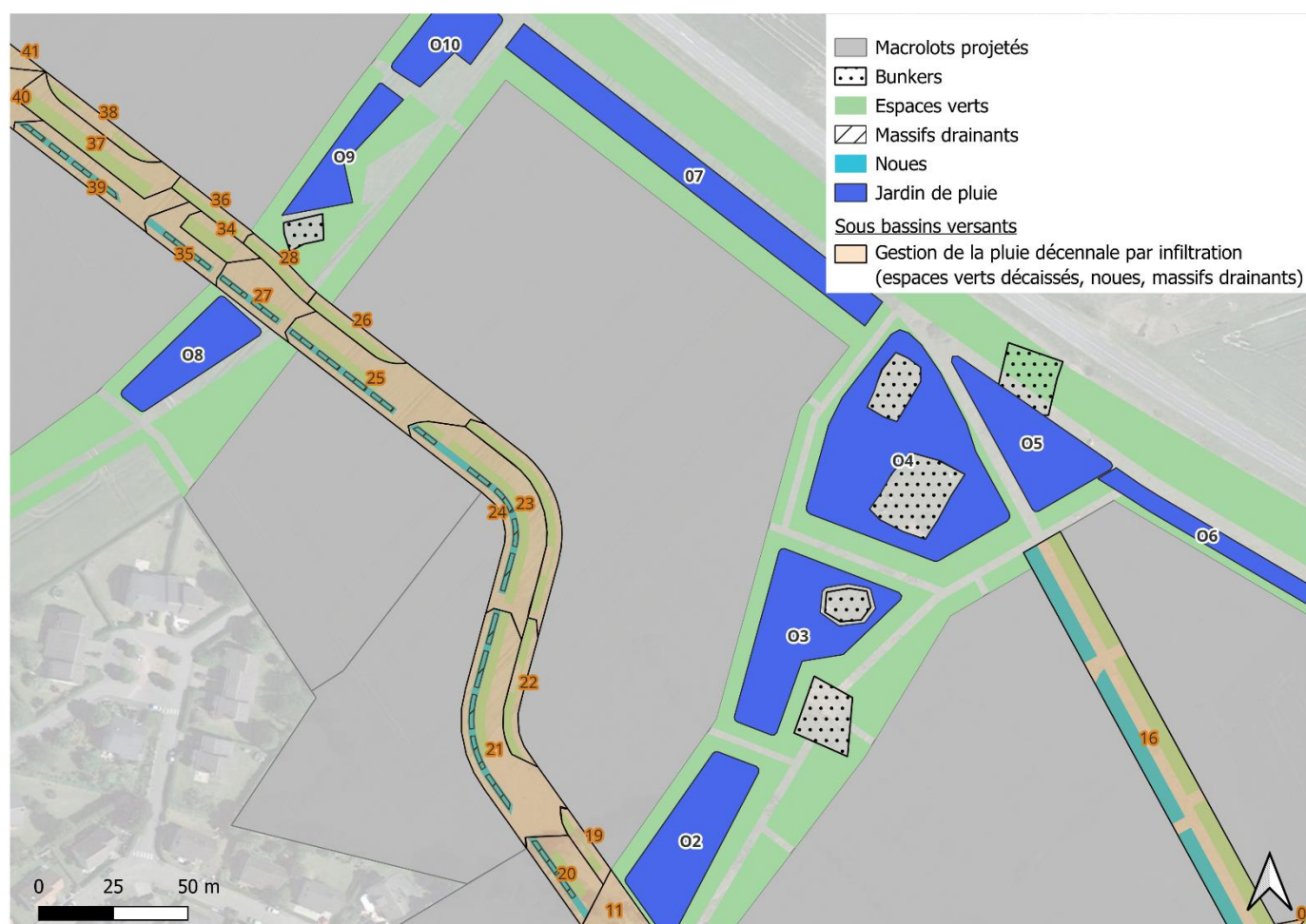
Figure 16 : Ouvrages assurant l'infiltration de la pluie décennale
