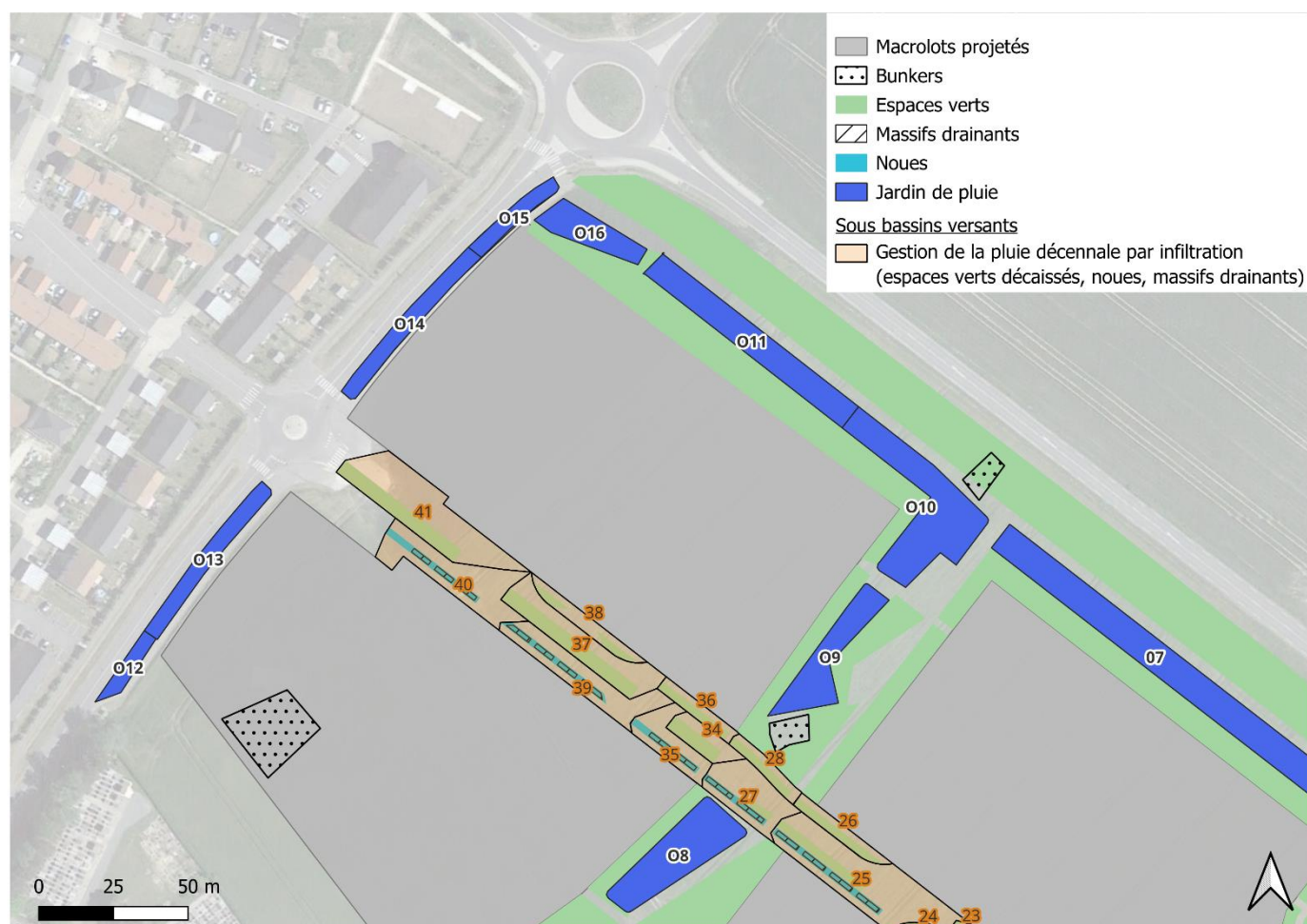
Figure 17 : Ouvrages assurant l'infiltration de la pluie décennale
