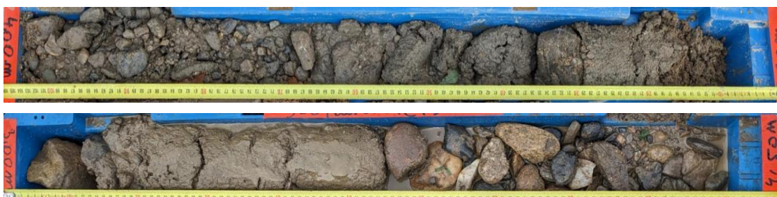
Figure 11 : Alluvions, SC6 et 7, Tronçon 2
