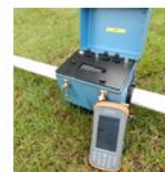
L'EM31-MK2 et le data logger ARCHER
