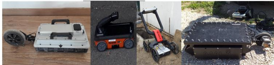
Les différentes antennes géoradar (750 MHz, 1600 MHz, 450 MHz), et le caisson d'immersion
