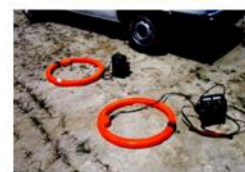
Les deux bobines de l'EM34 reliées à un système filaire
