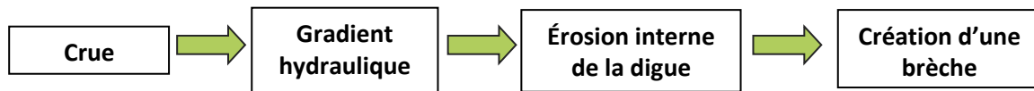
Figure 93 : Arbres de défaillance simplifiés d'un scénario de rupture de digue par érosion interne
