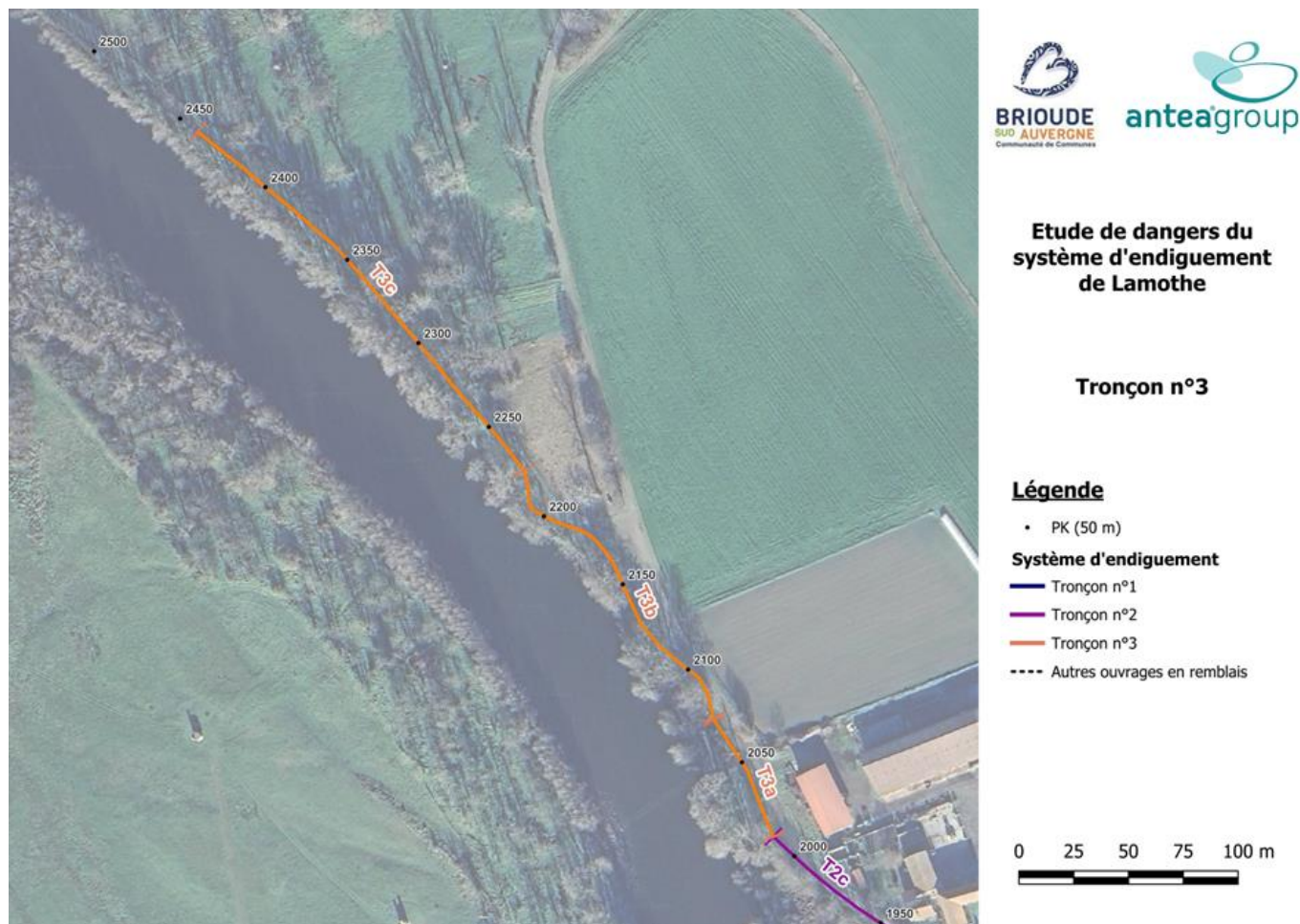
Figure 74 : Tronçon n°3 du système d'endiguement de Lamothe
