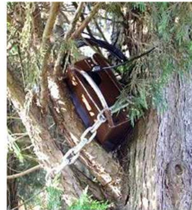
Enregistreur automatisé de type SM2 installé sur l'aire d'étude - Photo in situ
