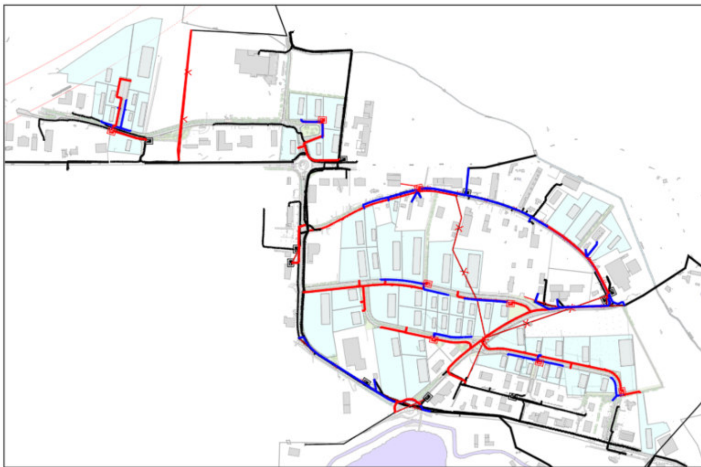
PLAN DE SYNTHÈSE DES RÉSEAUX ÉLECTRIQUES EXISTANTS (NOIR), À ENFOUIR (CROIX ROUGE) ET PROJÉTÉS (HAUTE TENSION EN ROUGE ET BASSE TENSION EN BLEU)
