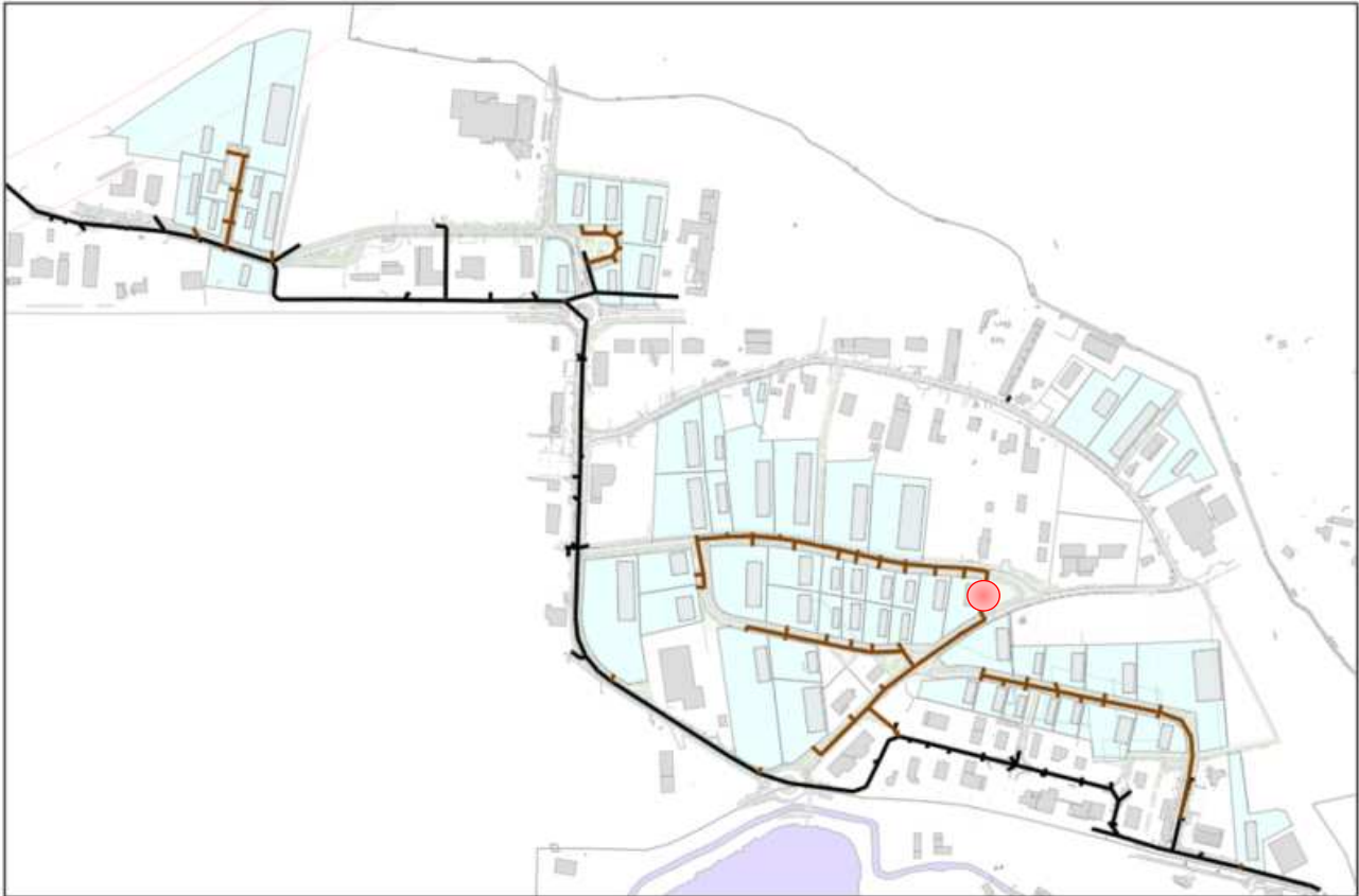
Figure 44 : plan de synthèse des réseaux eaux usées existantes (en noir) et projetés (en marron) (source : Etude d'Avant-Projet, Avril 2022)
