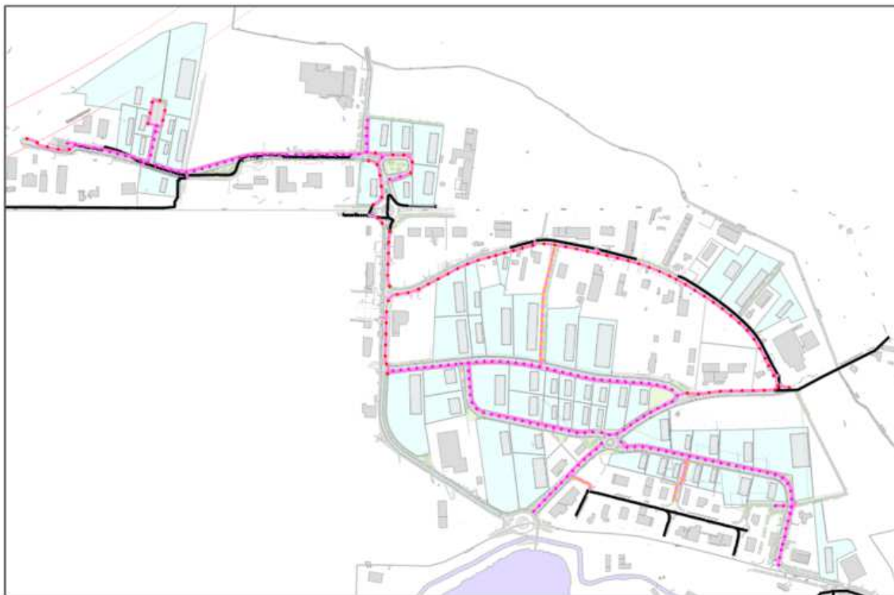
Figure 45 : Plan de synthèse des réseaux d'éclairage public (en noir : réseau existant / en rose : réseau projeté) (source : Etude d'Avant-Projet, Avril 2022)
