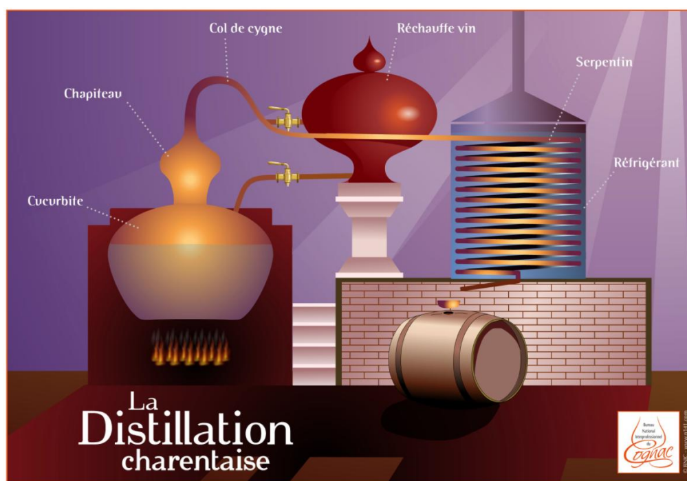
Figure 1. Constitution d'un alambic charentais
