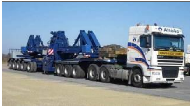
Photo 15 : Exemple de camion assurant le transport des composants d'un parc éolien
