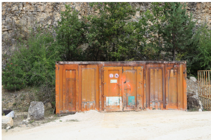
Container fermé contenant les huiles et lubrifiants sur bacs de rétention
