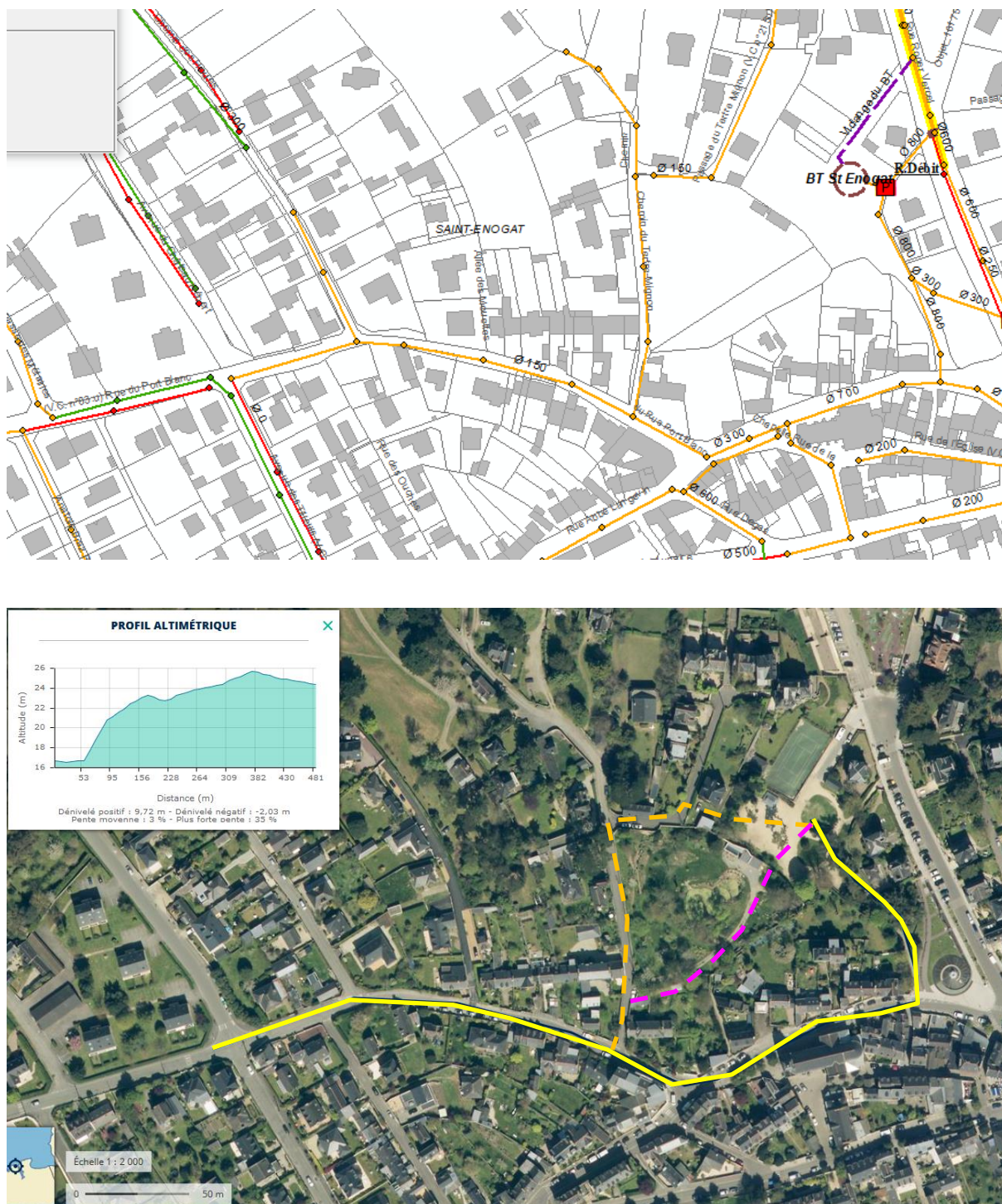
Figure 18 : Tracé et profil indicatif du possible refoulement du BT St Enogat
