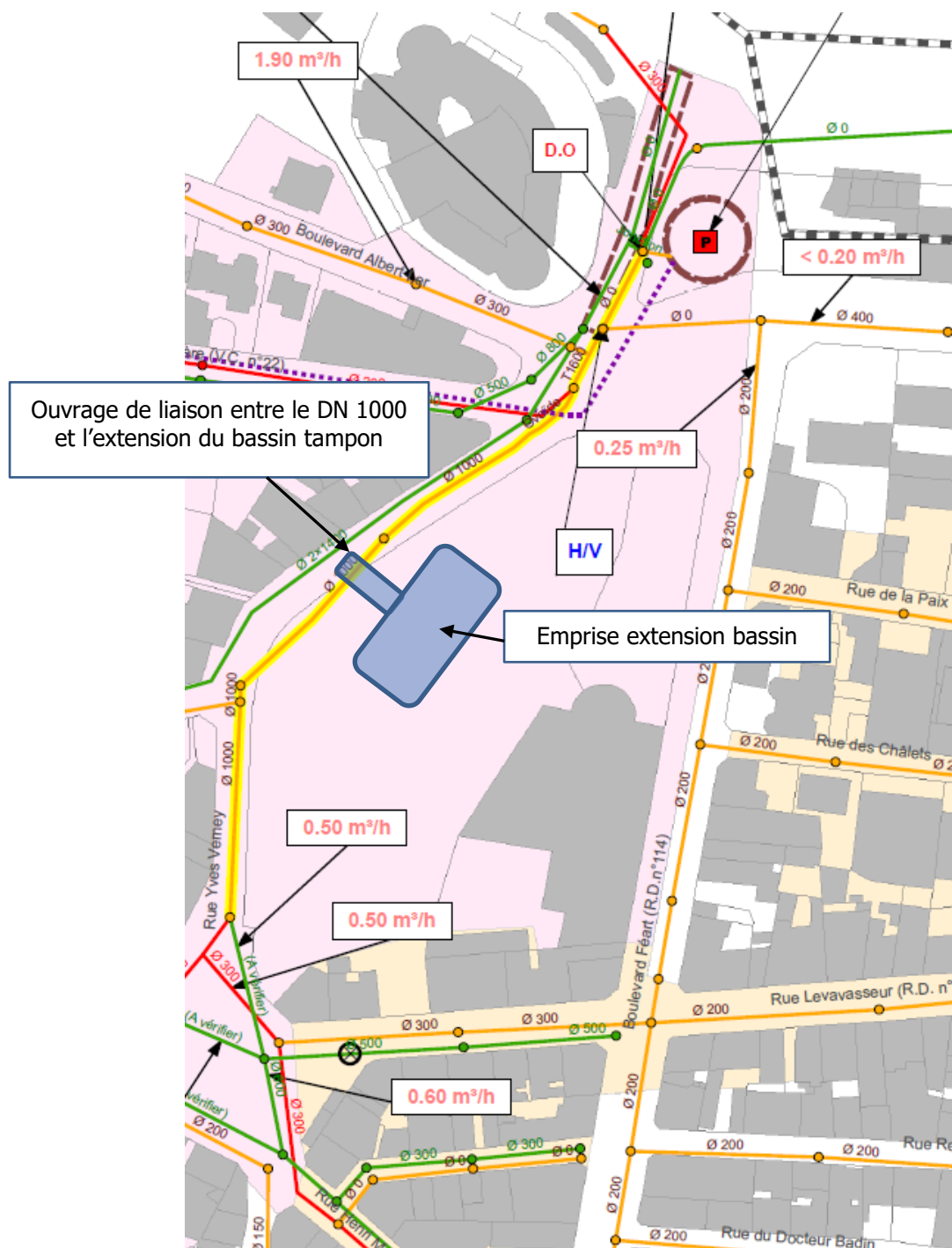
Figure 36 : Implantation d'un nouveau bassin tampon – PR Ecluse
