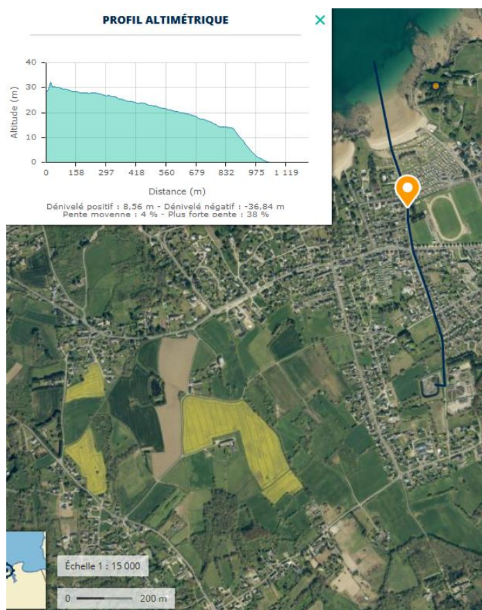
Figure 22 : Emissaire - partie terrestre - station d'épuration de Dinard
