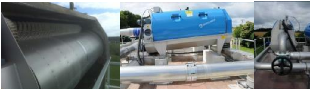
Figure 48 : Exemple de tamis rotatif
