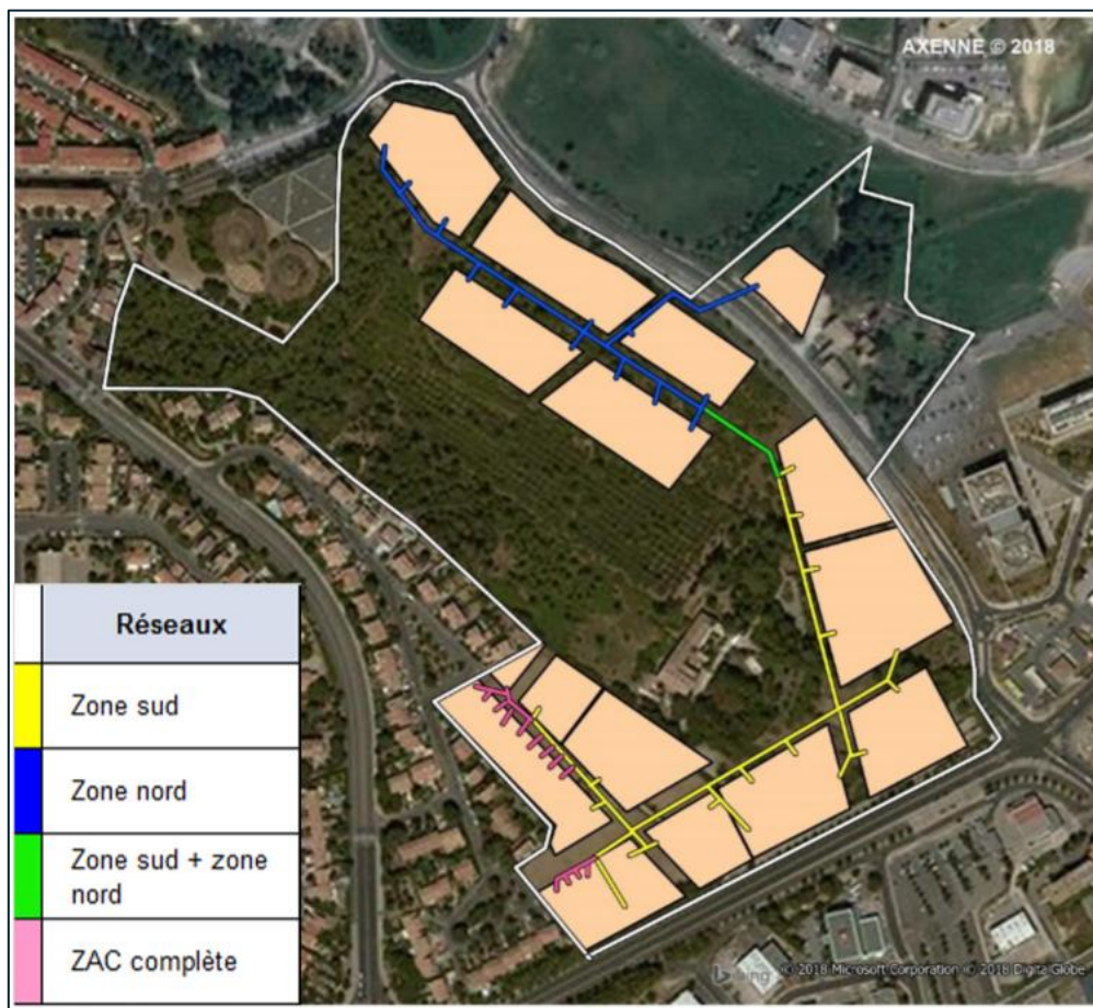
FIGURE 144 : TRACE ET EXTENSIONS DU RESEAU DE CHALEUR POTENTIEL DES BATIMENTS PAR LOT
