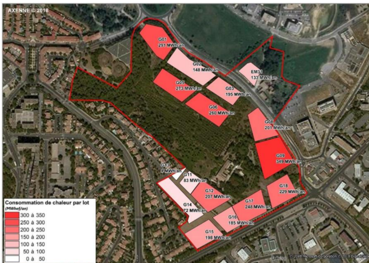
FIGURE 142 : CONSOMMATION D'ÉNERGIE FINALE POUR LE CHAUFFAGE DE TOUS LES BATIMENTS ET L'EAU CHAUDE SANITAIRE DES LOGEMENTS
