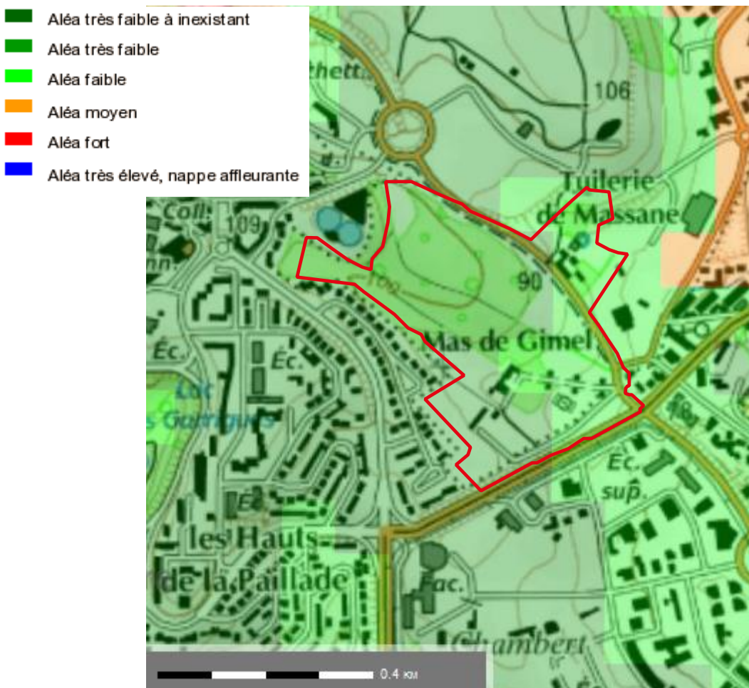
FIGURE 17 : RISQUE DE REMONTEE DE NAPPE
