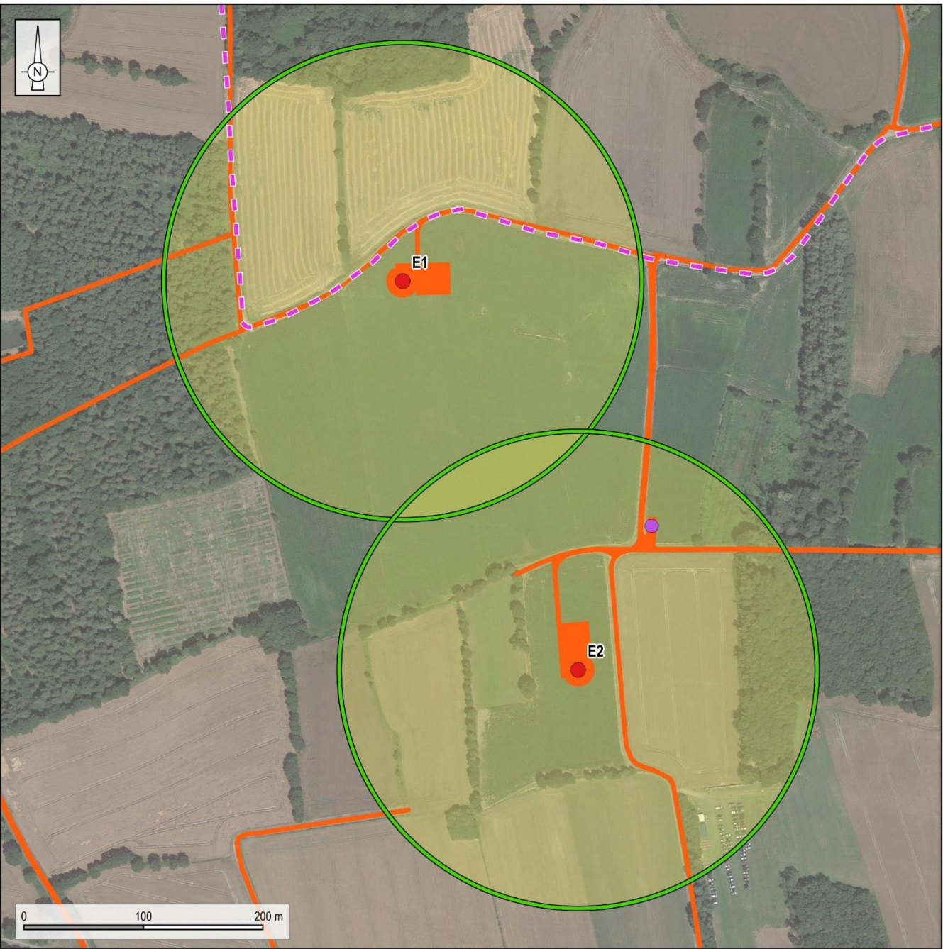
Cartographie des risques : scénario effondrement d'éolienne
