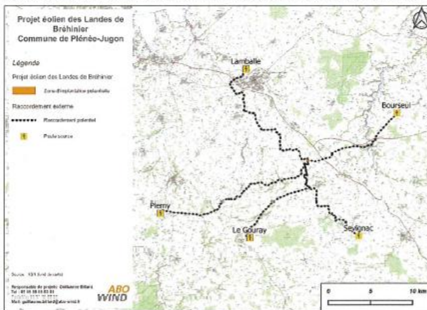
Figure 2 : Différents tracés électriques externes (source ABO Wind)
