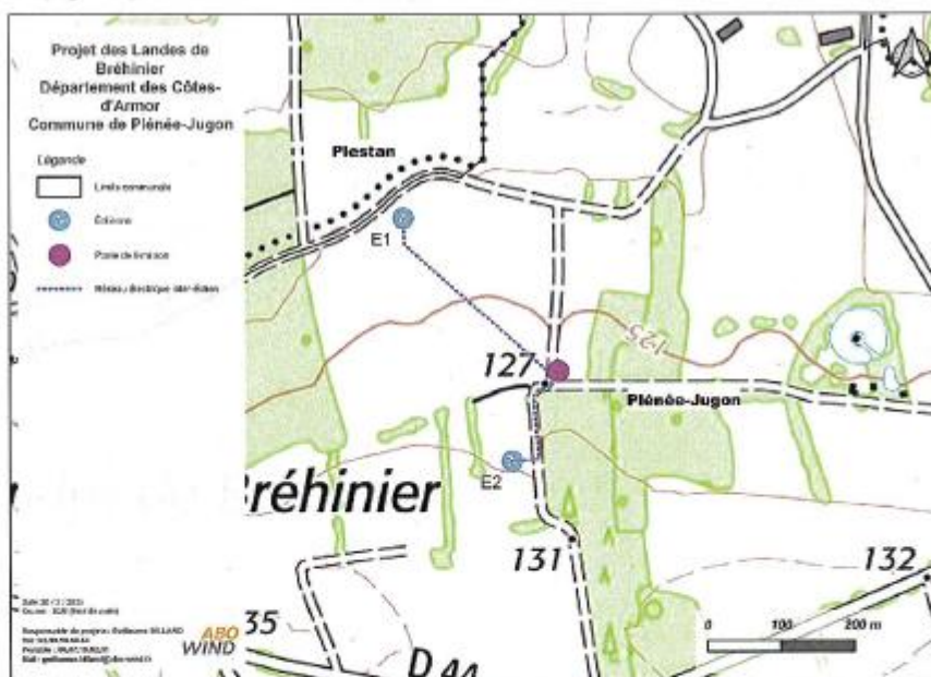
Figure 1 : Réseau électrique interne (source ABO Wind)
