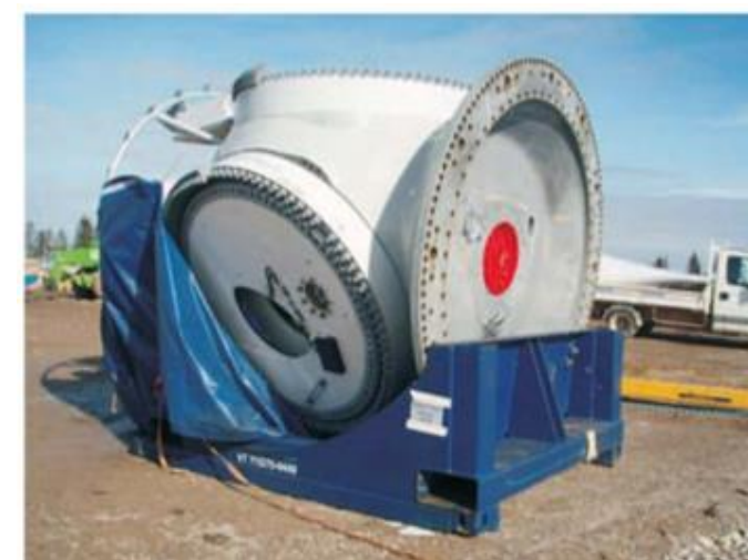
Photographie 2 : Stockage d'un rotor sur une plate-forme (Source : EDF Renewables)
