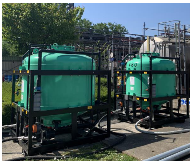
Figure 5 : Exemple de filtres de 2 m 3 (Desotec)
