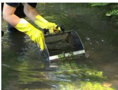
Photographie 1 : Prélèvement au filet Surber
