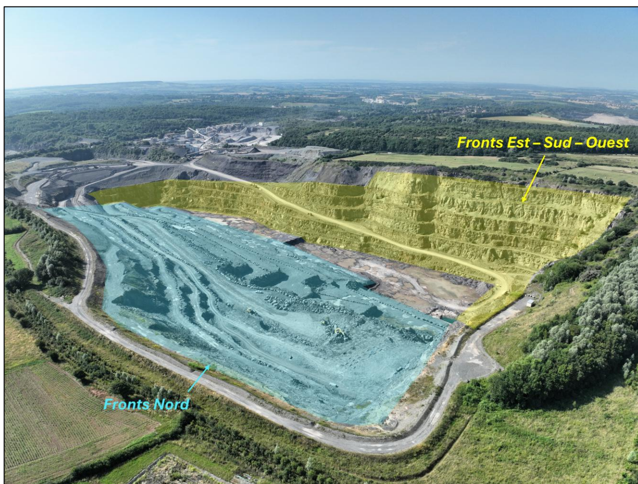
Figure 5. Etages et banquettes créés sur les fronts de la fosse d'extraction de la carrière du Banc Noir (source : Stinkal)
