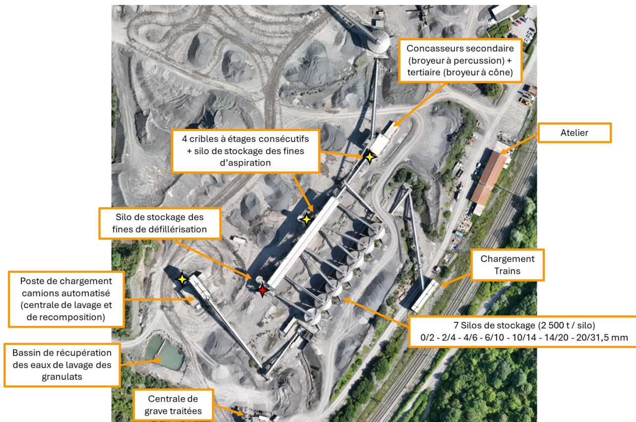
Figure 10. Vue aérienne de la chaîne de production secondaire et tertiaire (source : Stinkal)
