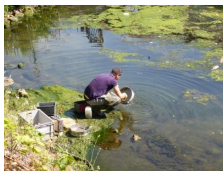
Photographie 2 : Tri par tamisage in situ
