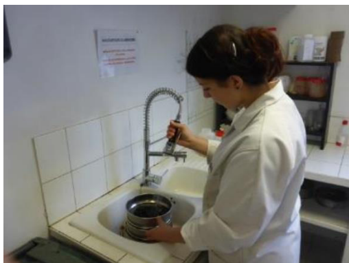
Photographie 3 : Nettoyage et tamisage des échantillons
