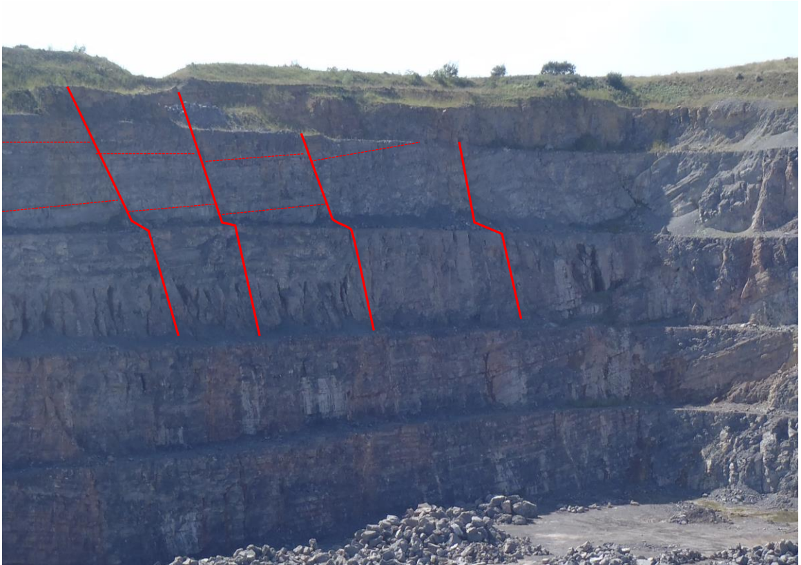
Photo 4 front Sud-Ouest affecté d'une série de failles avec faible re-jeux de la stratigraphie.
