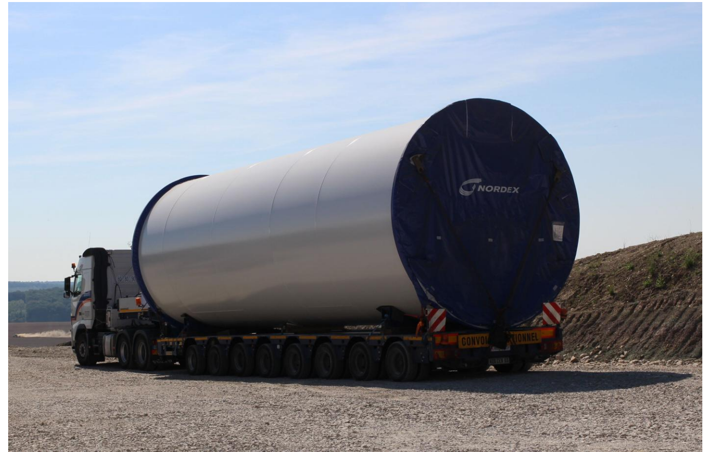
Photo 9 : Transport d'une section de mât d'éolienne © Ora environnement
