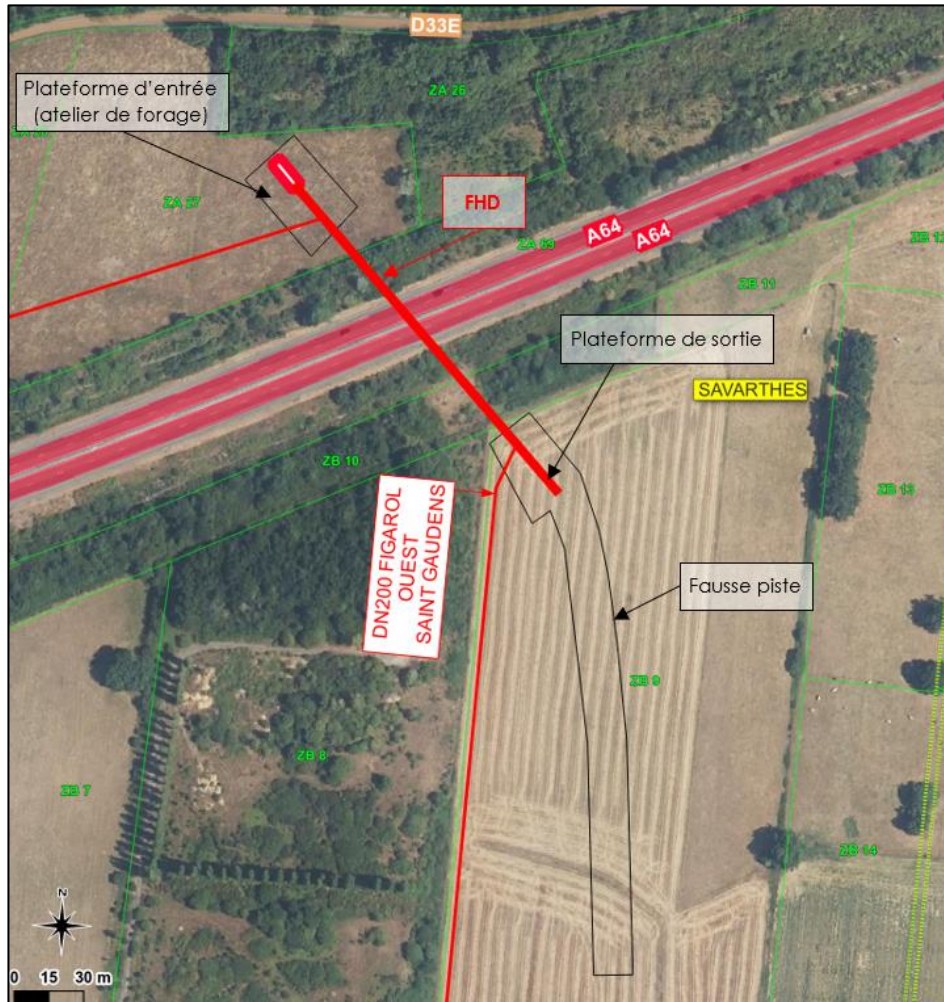
Figure 65 : Vue d'ensemble du site et des aménagements prévus – Franchissement de l'A64 à Savarhès
