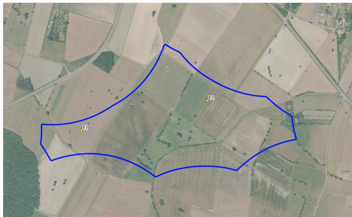
Figure 11. Implantation à 2 éoliennes, variante 2 (hauteur en bout de pale = 230m) et variante 3 (hauteur en bout de pale = 200m).
